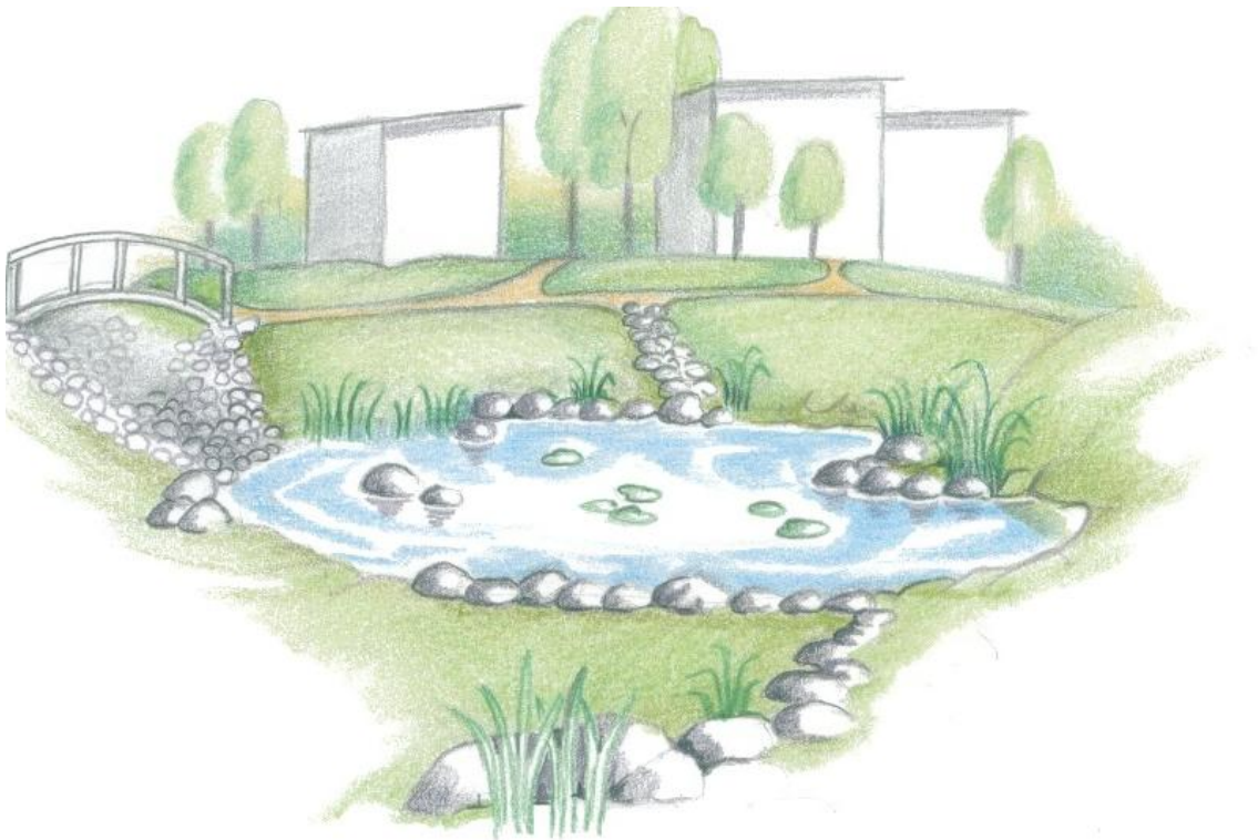
Kuva 6. Hulevesiallas (kuva: Ramboll/Taru Mäkiranta)
